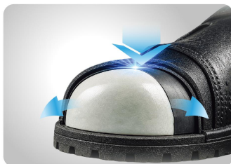
VortiGard™ Embout Composite (200J) Protection sans métal contre les risques d'impact.
